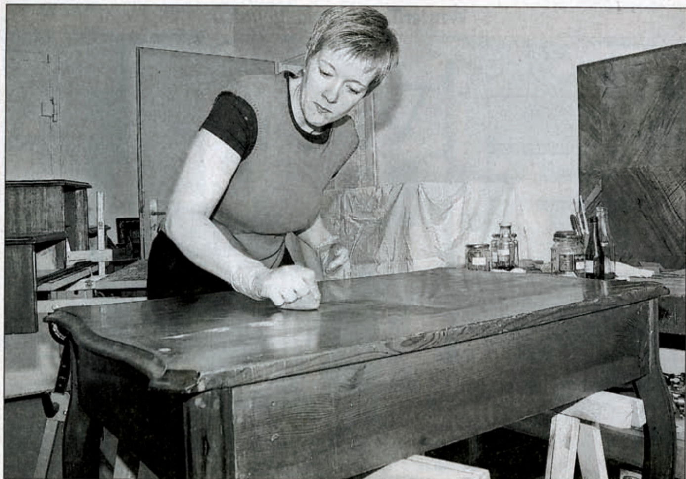
Neuer Glanz für einen Damenschreibtisch: Aileen Laska hat sich in Altlandsberg im Gewerbegebiet An der Mühle eine Werkstatt eingerichtet. Hier poliert sie die Oberfläche der Tischplatte mit Schellack, im Hintergrund der Aufsatz. Das gute Stück ist ungefähr 125 Jahre alt.
